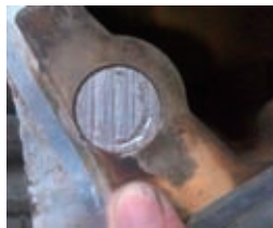
图4 将铝堵头用AB胶粘好
