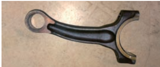
图5 另一台标致307则因汽缸进水导致连杆被压弯
