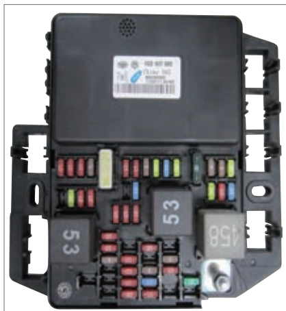
图1 J519控制单元正面图
