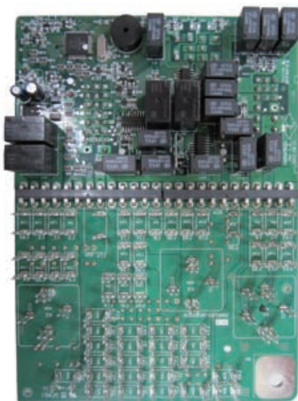
图3 J519控制单元印刷电路板正面 (上为A板, 下为B板)
