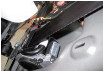
图2 卡箍金属针脚的塑料锁卡断裂
