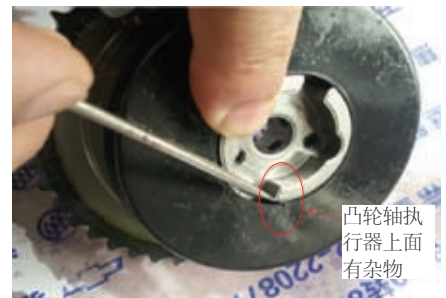
图2 进气凸轮轴执行器上面有杂物
