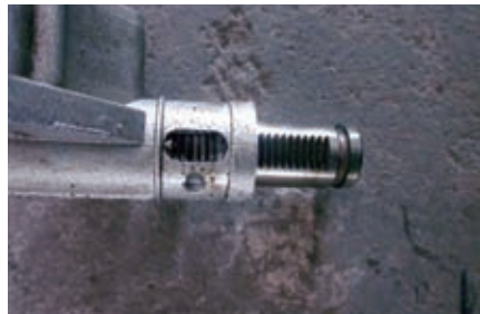
图1 损坏的涨紧器
