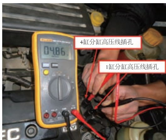
图2 检测1、4缸点火线圈次级线圈电阻值
