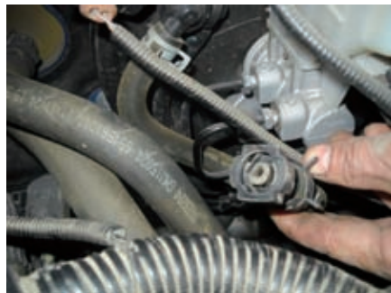
图2 真空助力器软管接头断掉
