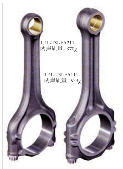
图73 重量优化的连杆
