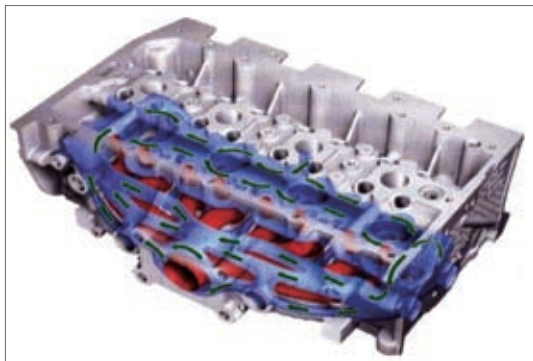
图71 带有整体式排气歧管的汽缸盖
