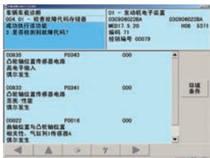
图1 控制单元存储故障码
