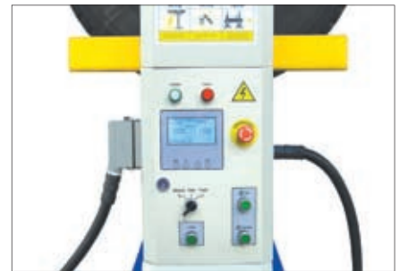
图18 主柱电控箱上的液晶显示屏
