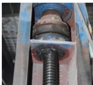
图8 丝杠/螺母易磨损
