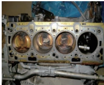
图2 4缸活塞断裂连杆弯曲, 3缸连杆弯曲
