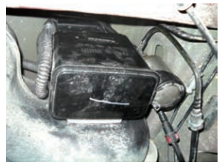
图4 炭罐里的水已满
