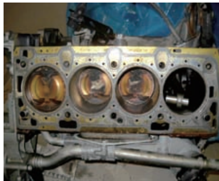
图2 4缸活塞断裂连杆弯曲, 3缸连杆弯曲
