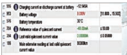
图2 读取后SAM中的电压实际值不正常
