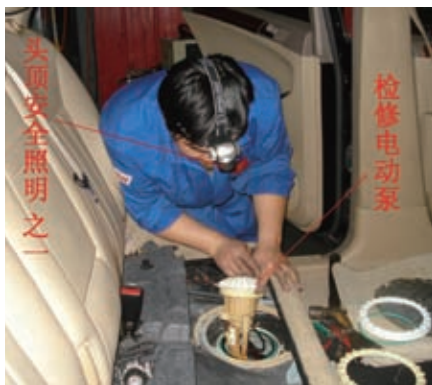
图5 头戴矿灯检修电动泵
