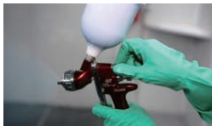
图2 顺时针旋紧涂料调节旋钮
