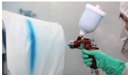
图4 喷涂一幅静态的竖形图案
