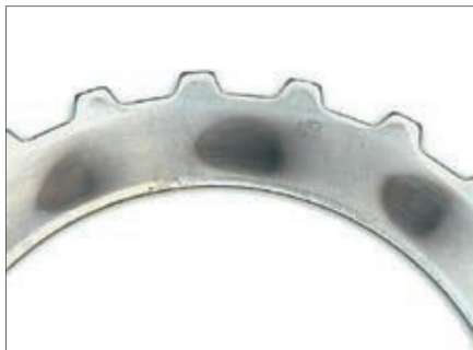
图1 离合器烧蚀出现间隔性的热点
