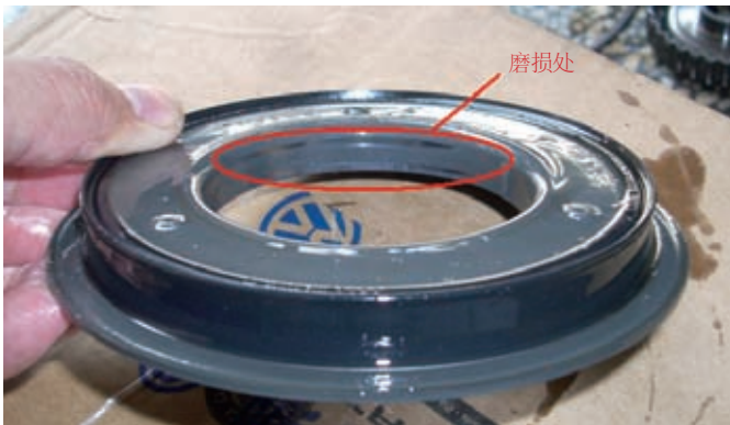
图20 有故障的K2离合器活塞
