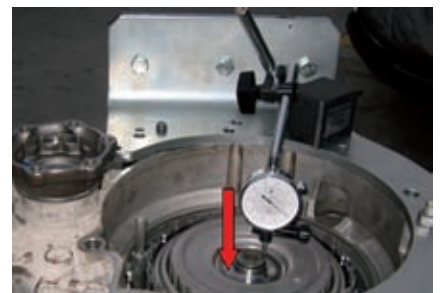
图16 大众DQ250型DSG离合器轴向间隙调整
