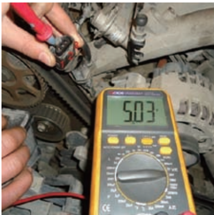
图2 检测凸轮轴位置传感器插头“1”号端子与搭铁之间的电压
