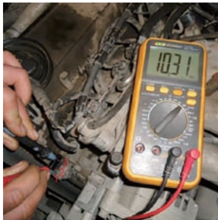
图3 测量凸轮轴位置传感器插座1号端子与3号端子电阻
