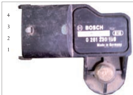
图1 进气压力传感器脚位示意图
