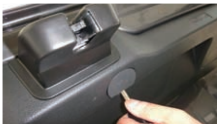
图5 用点火钥匙撬开后备厢锁芯的堵盖
