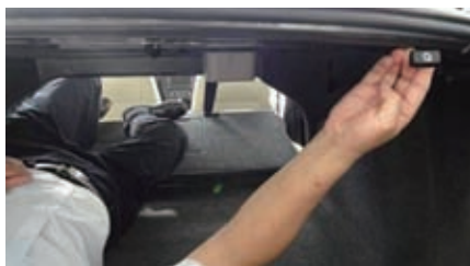
图4 推动双排椅背的解锁键并蹬倒双靠背
