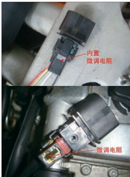
图1 传感器侧插头内置微调电阻
