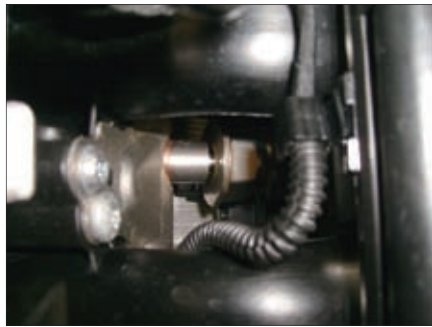
图3 燃油压力调节阀N276
