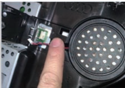
图1 仪表板的扬声器插头
