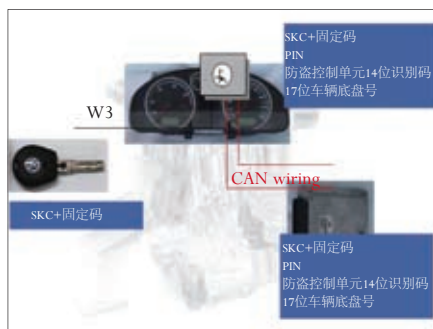
图1 第三代防盗器密码识别过程示意图
