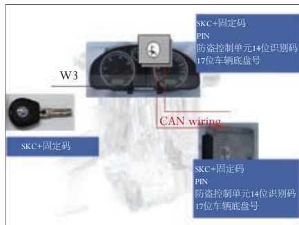
图1 第三代防盗器密码识别过程示意图
