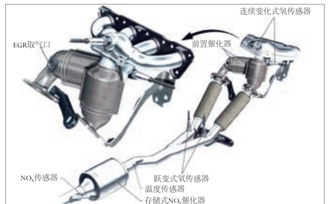
图18 排气及废气后处理系统
