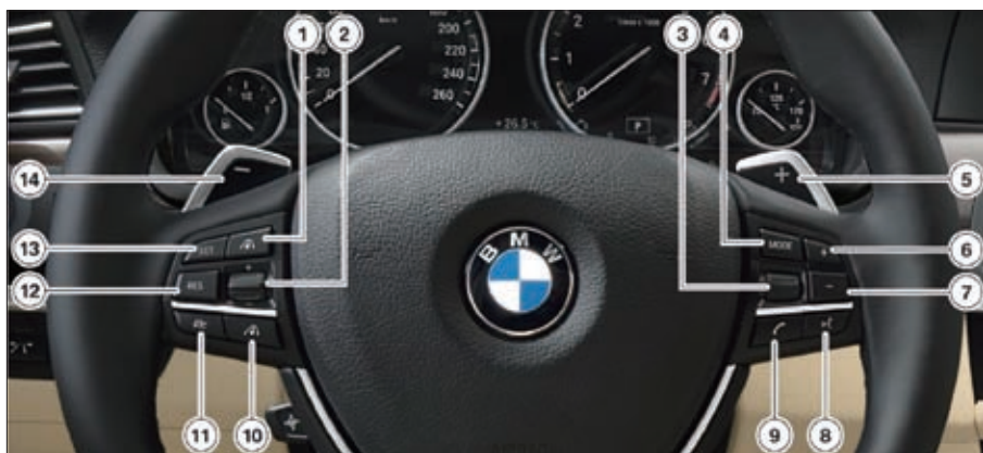
1-增加距离按钮(仅限可选配置5DF) 2-翘板开关±,变更速度,设置速度 3-滚轮,选择/设置电台或音轨 4-模式按钮,切换音频来源 5-上调挡位的换挡拨片(仅限SA 2TB) 6-翘板开关+,提高音量 7-翘板开关-,降低音量 8-语音识别系统按钮 9-电话按钮 10-缩短距离按钮(仅限可选配置5DF) 11-ACC/DCC开/关,中断 12-续航按钮,呼出已存储的速度 13-设置速度按钮 14-下调挡位的换挡拨片(仅限SA 2TB)
