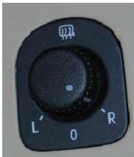
图3 大众速腾轿车车外电动后视镜加热器开关
