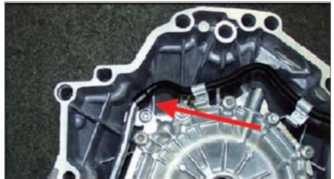
图47 橡胶软管位置
