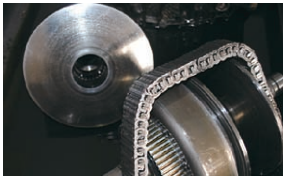
图42 严重磨损的链传动部件
