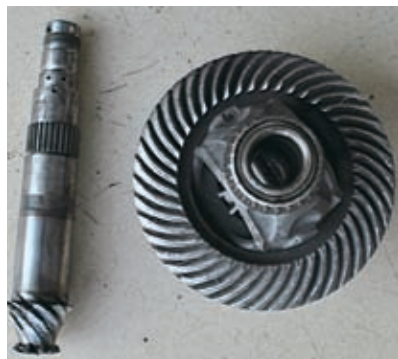
图43 严重烧损的奥迪CVT差速器
