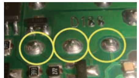
图41 奥迪01J型无级变速器电脑供电继电器内部焊点
