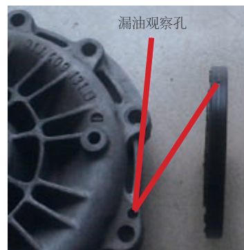
图44 奥迪差速器边盖漏油观察孔
