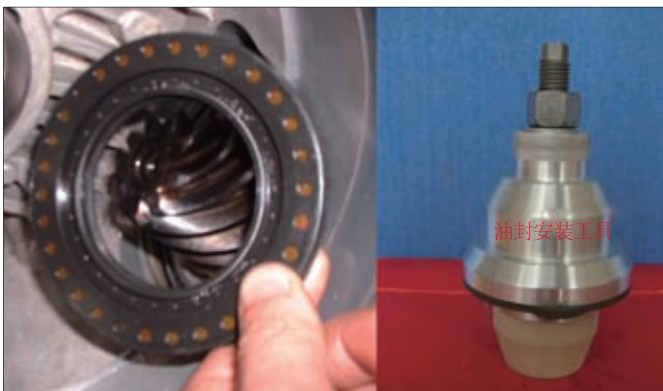
图45 奥迪CVT变速器差速器双唇面油封安装
