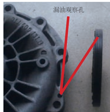
图44 奥迪差速器边盖漏油观察孔
