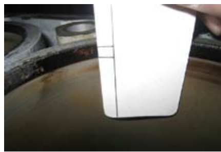
图3 用深度标尺检查各汽缸活塞上止点高度
