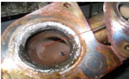
图2 检查进气歧管进水状态
