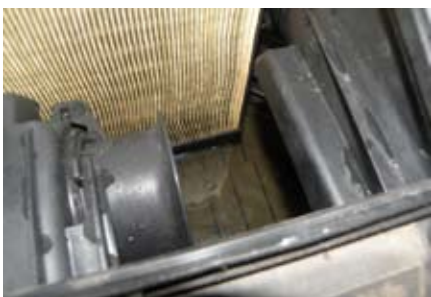
图1 检查空气滤芯的进水状态
