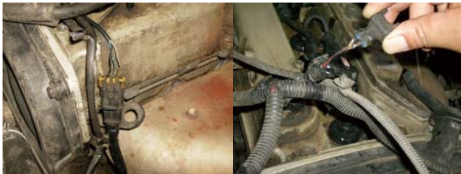
图1 发动机电控线束和曲轴位置传感器连接器线路绝缘层开裂
