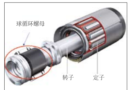
图3 电动机械式助力转向电机V187
