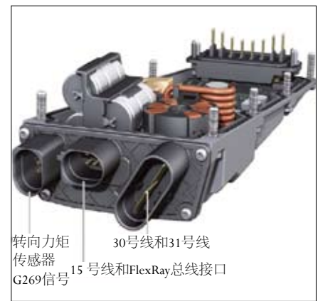
图7 转向助力控制单元J500外部插接头
