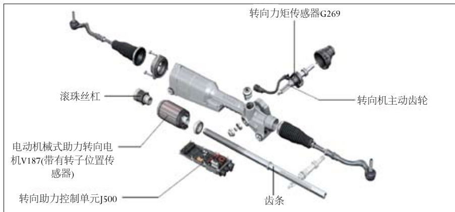
图1 转向机结构示意图
