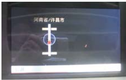
图1 Comand显示屏显示的位置不正确
