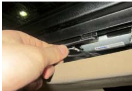
图3 磨破的GPS天线线束
