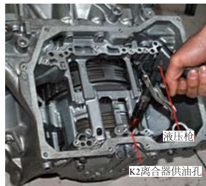
图66 利用液压设备进行09G变速器中的离合器和制动器进行加压试验
