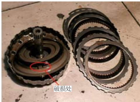
图67 损坏的09G变速器K2离合器主活塞橡胶密封处
