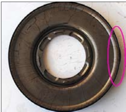
图69 损坏的09G变速器K1离合器副活塞
