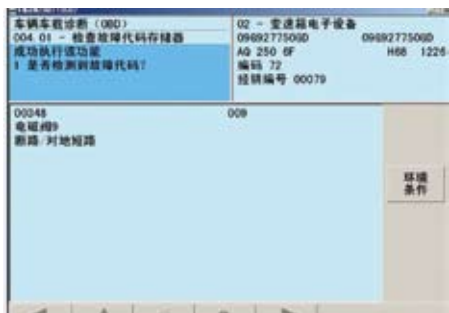
图72 电控系统记录的关于某电磁阀故障
