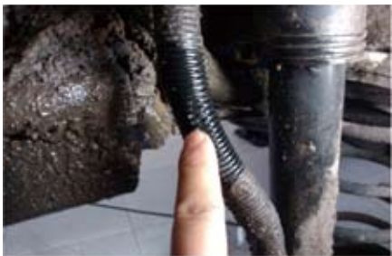
图1 乐风油箱油气回排软管
