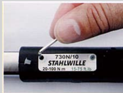
图3 使用普通内六角扳手从外部进行调节
