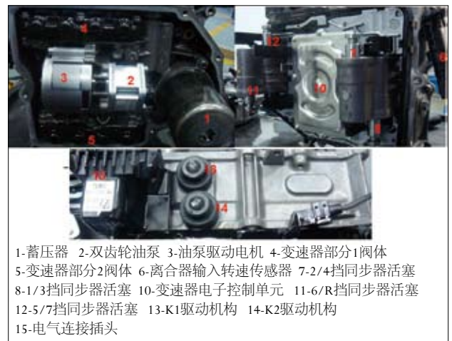
图14 电-液控制单元各部件安装位置示意图
