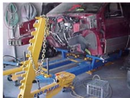
维修一体式车身时需要精度更高的设备
