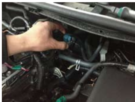
图2 用手触摸活性炭罐开口
