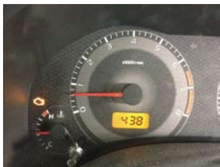
图3 堵住活性炭罐开口端转速下
