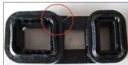
图4 损坏的过桥油封
