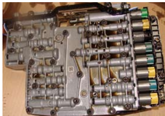
图1 带电子挂挡杆的6HP19变速器电子液压模块
