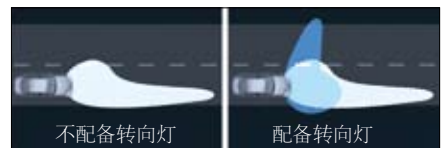
图24 自适应随动前照灯中配置转向灯照明效果图
