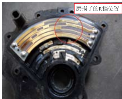
图4 挡位开关有磨损和氧化迹象
