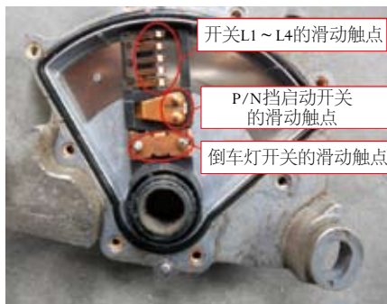
图3 挡位开关各滑动触点的名称与功能
