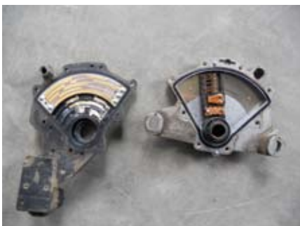
图2 4HP-16自动变速器挡位开关分解图
