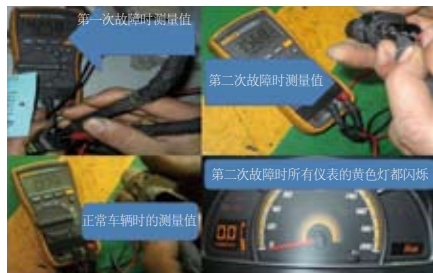
图1 万用表测量车速传感器
