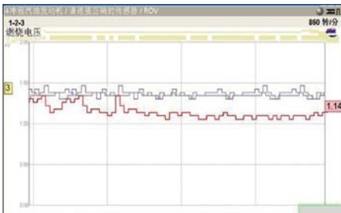
图8 高压线漏电时的燃烧电压趋势图
