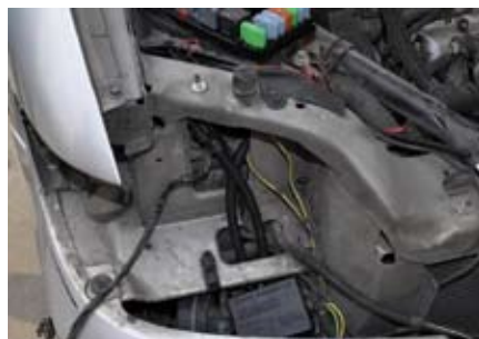
图1 拆卸右前大灯, 把风扇模块固定在空旷位置
