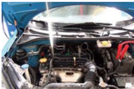
图1 发动机汽缸内的水通过火花塞的孔排出
