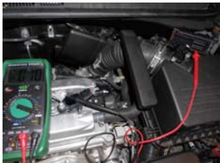
图4 检查ECU控制线与喷油器线路是否相通
