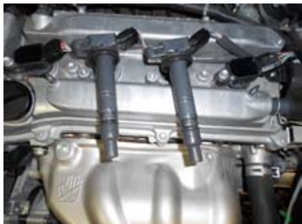
图2 将3缸的点火线圈与2缸对调
