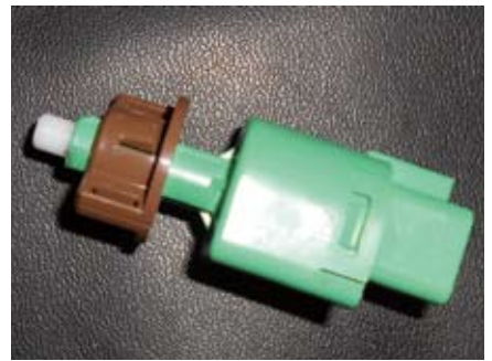
图6 所更换的制动开关
