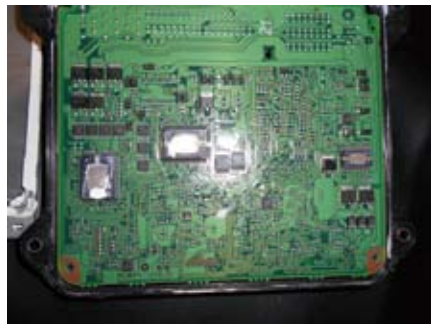
图5 损坏的喷油器驱动贴片三极管
