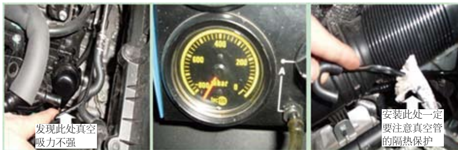
图2 检查进气管风门控制真空阀门的真空管路
