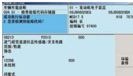
图1 读取发动机控制单元故障码
