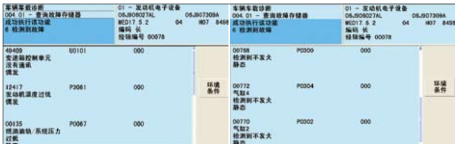
图1 发动机系统故障码截屏
