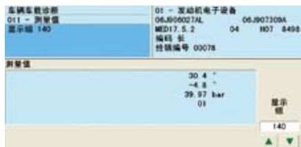
图5 发动机140组数据显示正常
