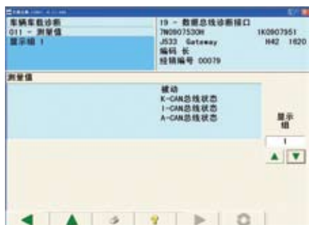
图6 拔下J527的T16f插头后J533的数据流截屏
