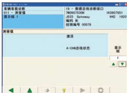
图1 19-网关控制单元的数据流
