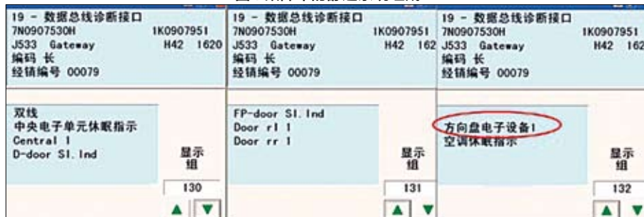
图5 舒适系统各控制单元数据流截屏
