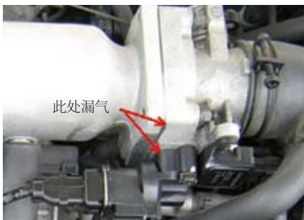
图3 节气门密封垫漏气
