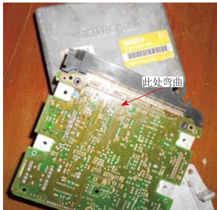
图2 电路板弯曲变形
